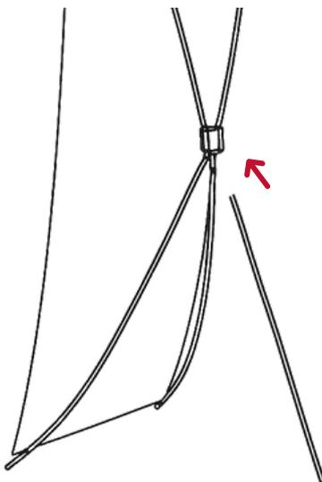
**Insérer la dernière partie du mât permettant de stabiliser la structure.**
